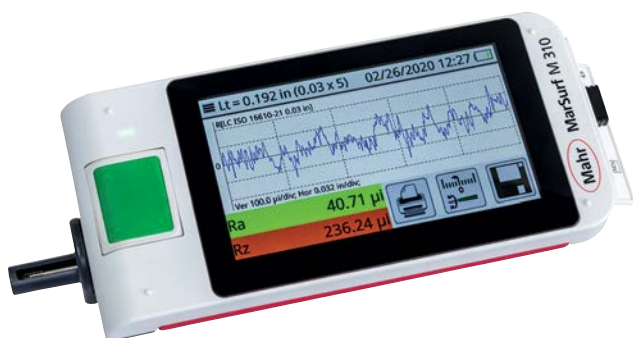
Miernik chropowości MarSurf M 310 z adapterem bezprzewodowym USB
